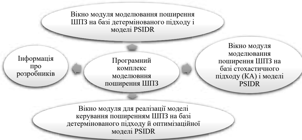
Рис. 2. Структура програмного комплексу моделювання поширення шкідливого програмного забезпечення
